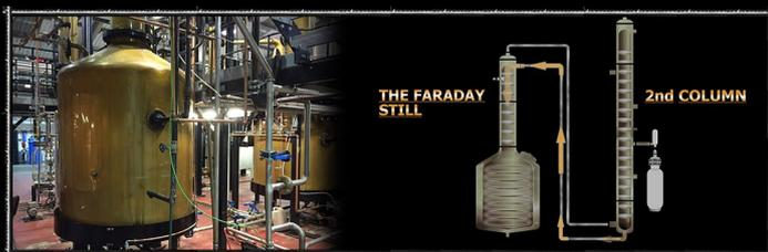
ペンダーリンで使用されるスチルは、単式蒸留器と連続式蒸留器が組み合わさったような特殊な構造で、スコットランドにもアイルランドにもないユニークなものです。一度の蒸留に必要な電力は、モルトウイスキーを単式のポットスチルで2回蒸留するよりも少なく、エネルギー消費を抑え、環境にも優しい最新技術を導入しています。この蒸留器を発明したのはデイヴィッド・ファラデー博士で、19世紀英国の大科学者と称えられるマイケル・ファラデー※の子孫にあたります。現在、このタイプのスチル2基と、従来からのポットスチル2基を使用し、92度の非常にクリーンなアルコールを製造しています。
